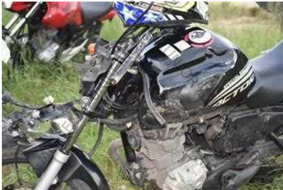
Figura 25. Avarias aparentes caracterizadas por amogaduras do sistema de suspensão dianteira, do tanque de combustível e fraturas do paralamas dianteiro, painel de instrumentos, farol dianteiro e carenagem do tanque de combustível.
