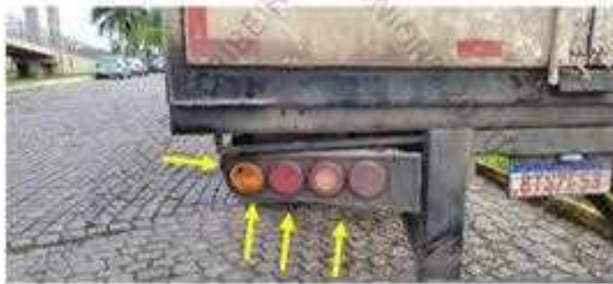
Figura 8. Semirreboque. Avarias evidenciadas por amolgaduras, atritamentos e fraturas localizadas no suporte de sustentação de lanternas esquerda de posicionamento e de indicação de direção decorrente da ação contusa de instrumento contundente dotado de energia mecânica orientada de trás para frente.
