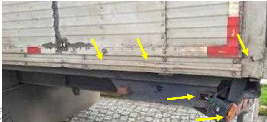
Figura 13. Semirreboque. Avarias evidenciadas por amolgaduras, atritamentos e fraturas localizadas no suporte de sustentação de lanternas esquerda de posicionamento e de indicação de direção decorrente da ação contusa de instrumento contundente dotado de energia mecânica orientada de trás para frente.
