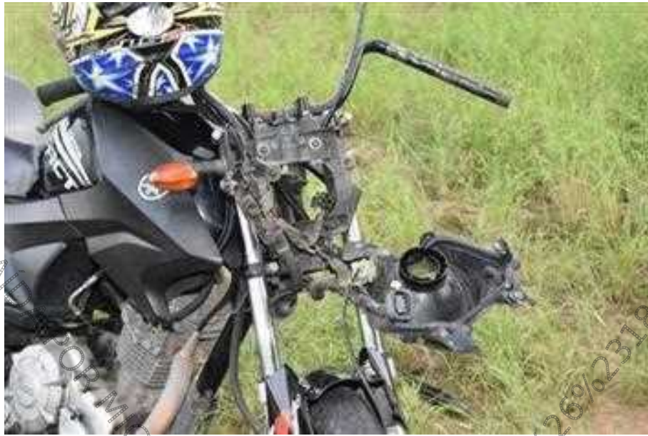
Figura 24. Avarias aparentes caracterizadas por amogaduras do sistema de suspensão dianteira, do tanque de combustível e fraturas do paralamas dianteiro, painel de instrumentos, farol dianteiro e carenagem do tanque de combustível.
