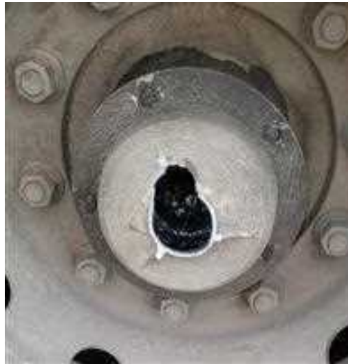
Figura 17. Semirreboque. Avarias evidenciadas por fratura da tampa do cubo de roda em decorrência do embate de instrumento contundente dotado de energia mecânica orientada de trás para frente.
