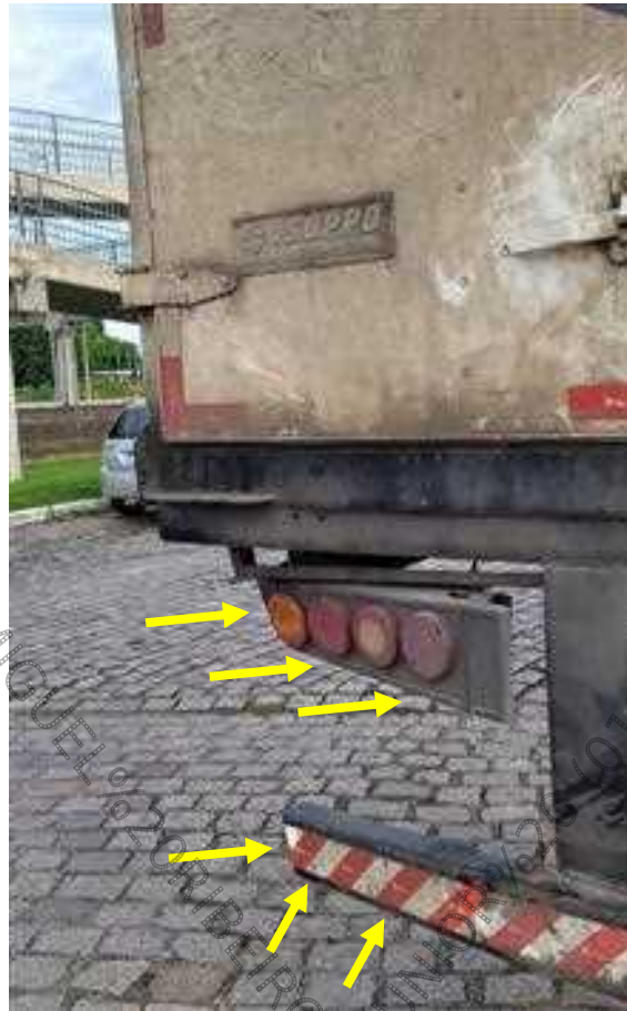
Figura 9. Semirreboque. Avarias evidenciadas por amolgaduras e atritamentos localizadas no para-choques traseiro decorrente da ação contusa de instrumento contundente dotado de energia mecânica orientada de trás para frente.
